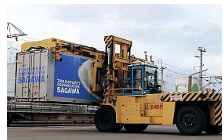
スーパーレールカーゴからトラックに、コンテナへの積み替えがどんどん行われています
